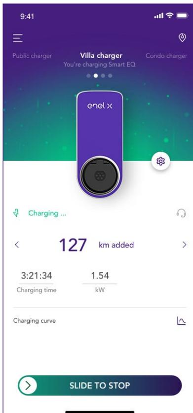
Um den Ladevorgang zu stoppen, wählen Sie **SLIDE TO STOP** in der JuicePass App. Der Ladevorgang wird automatisch gestoppt und das Ladekabel kann entfernt werden.
